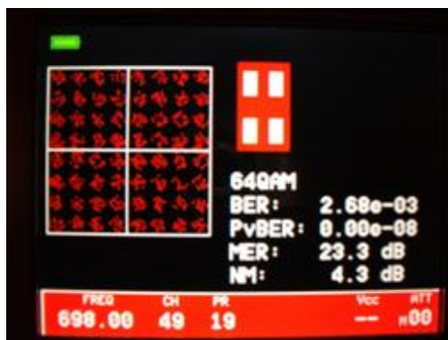
Segnale DVB-T 64 QAM qualità scarsa evidente presenza di rumore
